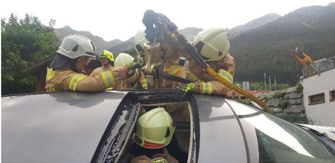
Beim Verkehrsunfall wurde ein PKW welcher an der Böschung hängegeblieben war, gesichert und anschließend die Insassen mit dem Spreizer und der Bergeschere befreit.
